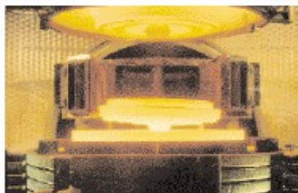
恒温鍛造の航空宇宙用合金ディスク (United Technologies/Pratt&Whitney)
